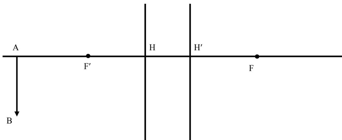
2、如图所示，已知理想光学系统的一对主平面和焦点位置，作图求轴上点 A 的像  $A'$ 。
